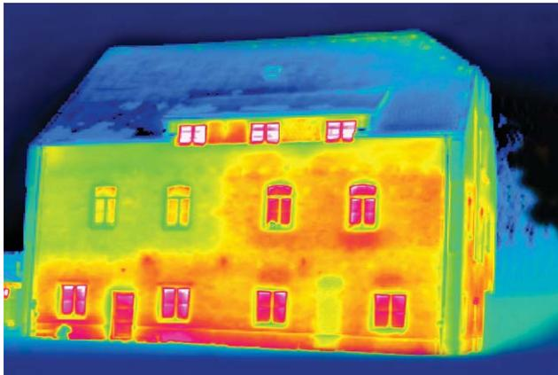
Wie auf dem Wärmebild an den beiden Fenstern oben links zu sehen, gleichen sanierte Fenster die Oberflächentemperatur der Verglasung an die der übrigen Bauteile an. Es geht weniger Wärme verloren, gleichzeitig steigt der Wohnkomfort und die Behaglichkeit.
