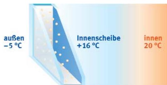
3fach Isolierglas mit Beschichtung und Gasfüllung
