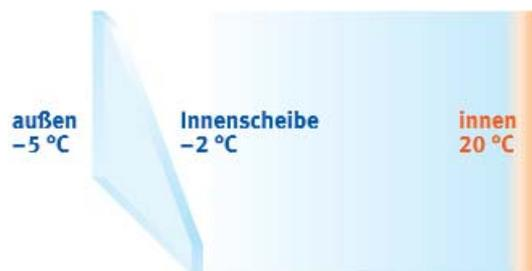
2fach Isolierglas mit Beschichtung und Gasfüllung
