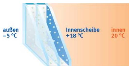
Bei der Wahl des richtigen Isolierglases, das die Infrarotstrahlung reflektiert und damit die Heizwärme im Inneren hält, muss auch die Ausrichtung des Gebäudes berücksichtigt werden. Räume mit hoher Sonneneinstrahlung benötigen weniger starke Isoliergläser als Gebäudeteile, die ständig im Schatten liegen.
