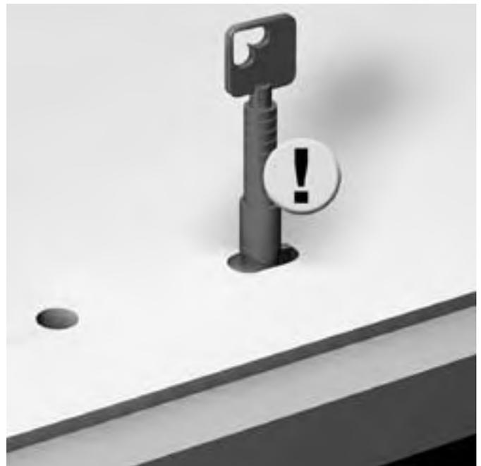
Bei nicht eingebautem Originalzylinder die Tür nur mit dem ROTO-Bauschlüssel versperren bzw. entriegeln.
