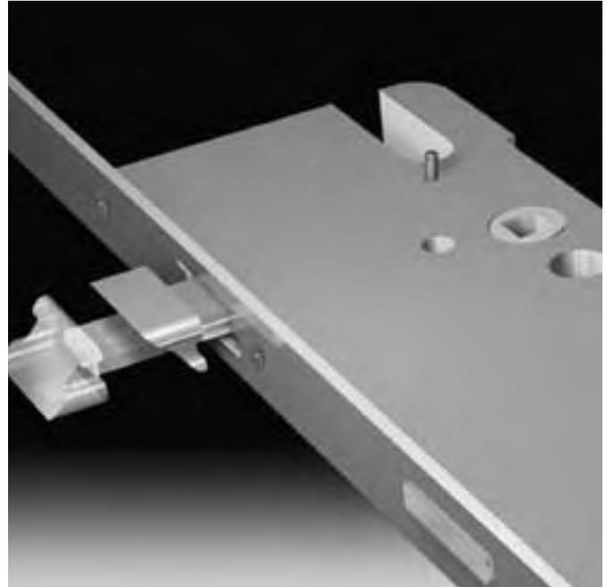
Auf der Vorderseite des Schlosses Stift bis zum Anschlag herausziehen, Falle herausziehen, um 180 Grad drehen und wieder einschieben.
