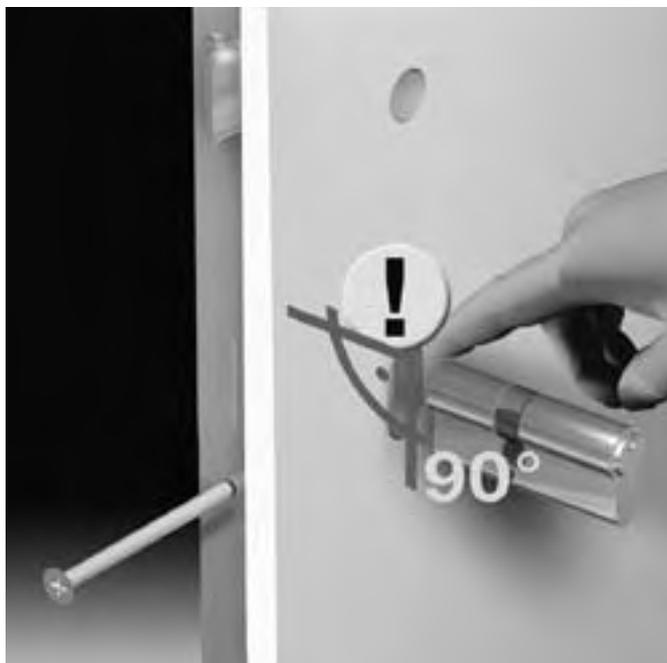
Zylinder spannungsfrei einbauen bzw. 90 Grad hin zum Türblatt ausrichten.
