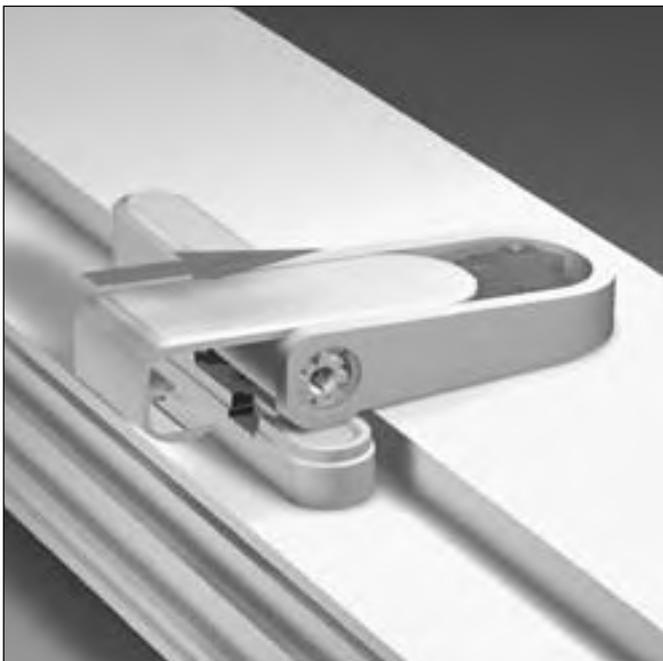
Aufschieben der Flügelbandabdeckung und Sichern gegen unbefugte Demontage mittels beigefügter Sicherungsschraube.
