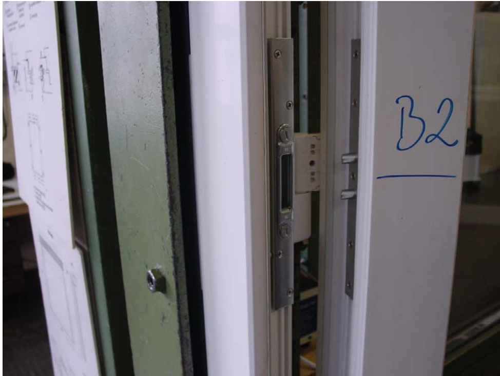
Bild 3 Band und Bandsicherung des Probekörpers
